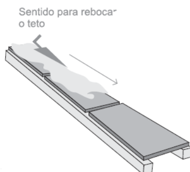
Figura 46 - Sentido para rebocar o teto FONTE: Brito (2002)
